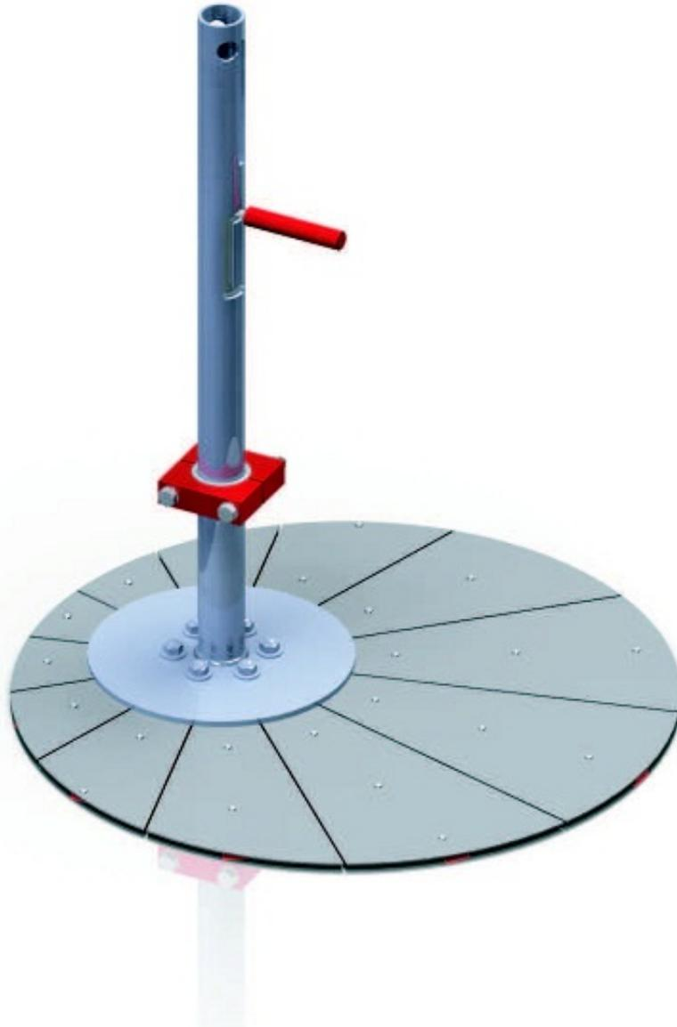
**Назначение:** диск -отражатель ОТР применяется с целью сокращения потери нефтепродуктов от больших «дыханий» на 25 — 30%. Использование дисков-отражателей наиболее эффективно в таких нефтяных резервуарах, где имеется большой коэффициент оборачиваемости.
