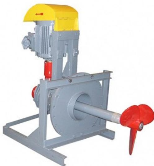
**Назначение:** поворотные мешалки Серии- Д с углом отклонения выходного вала  $\pm 30^\circ$ , электродвигателями 7,5; 11; 22 кВт и с двойным торцовым уплотнением выходного вала предназначены для перемешивания ЛВЖ (нефть, бензин, керосин, дизельное топливо) резервуарах объемом от 500 до 5000 м<sup>3</sup>.
