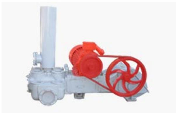
**Назначение:** насос поршневой электроприводной ЭНП-100 предназначен для перекачивания нефтепродуктов с температурой до +100°C; и кинематической вязкостью до 6 сСт (при номинальном режиме) в условиях нефтебаз. ЭНП-100 оснащен взрывозащищенным двигателем.
