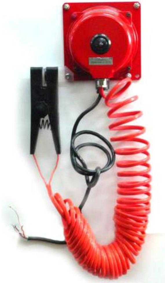
**Назначение:** устройство УЗА-4 (УЗА-4К и УЗА-4А) применяется с целью заземления автоцистерн и других транспортных резервуаров, чтобы избежать заряда статического электричества во время слива-налива нефтепродуктов и других легковоспламеняющихся веществ. Одновременно при этом контролируется сопротивление заземляющей цепи и блокируется включение насоса при сопротивлении заземляющей цепи более 100 Ом.
