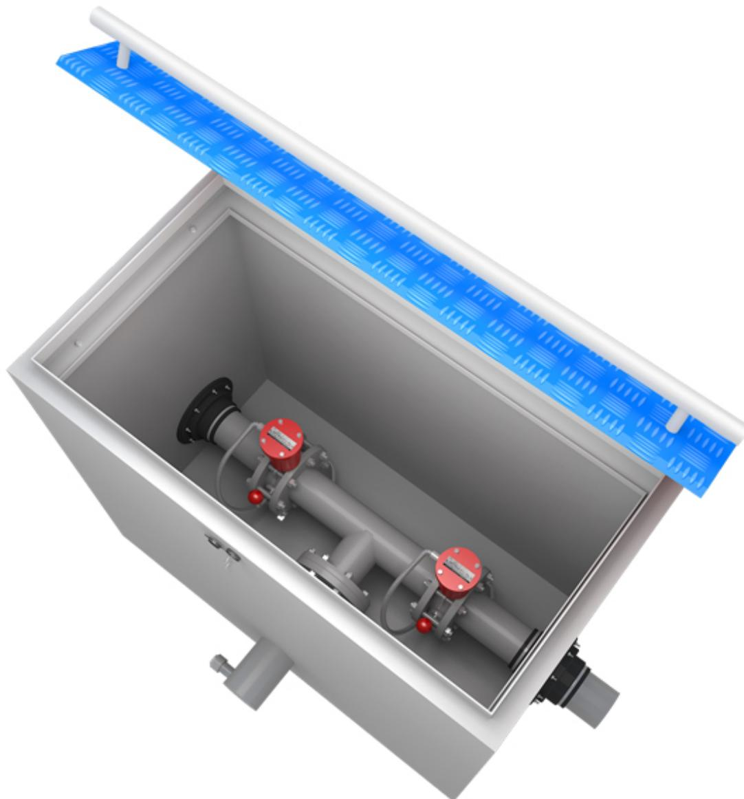
Основной функцией технологического отсека переключения аварийного пролива является размещение и защита технологического оборудования от внешнего воздействия различных факторов. В отсеке предусмотрена установка системы переключения, состоящей из [крана шарового](#) или электромагнитного клапана ЭМК, которая выполняет функцию переключателя между резервуаром приема аварийных проливов и очистными сооружениями АЗС.
