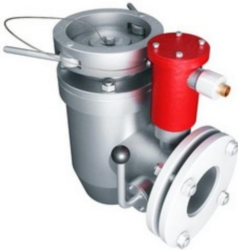
**Назначение:** узел наполнения УН-80Э с ЭМК является соединительным звеном между патрубком рукава автомобильной цистерны (АЦ) и трубопроводом линии наполнения резервуара.
