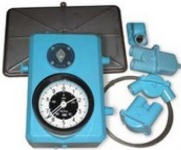
**Назначение:** уровнемеры УДУ-10 — резервуарное оборудование, используемое для определения уровня нефти в технологических аппаратах, наземных резервуарах (горизонтальных/вертикальных), подземных заглубленных резервуарах, в резервуарах с плавающей крышей, с понтоном. Поплавковые уровнемеры изготавливаются в расчете на жидкости разного удельного веса, а потому подходят и для различных нефтепродуктов.
