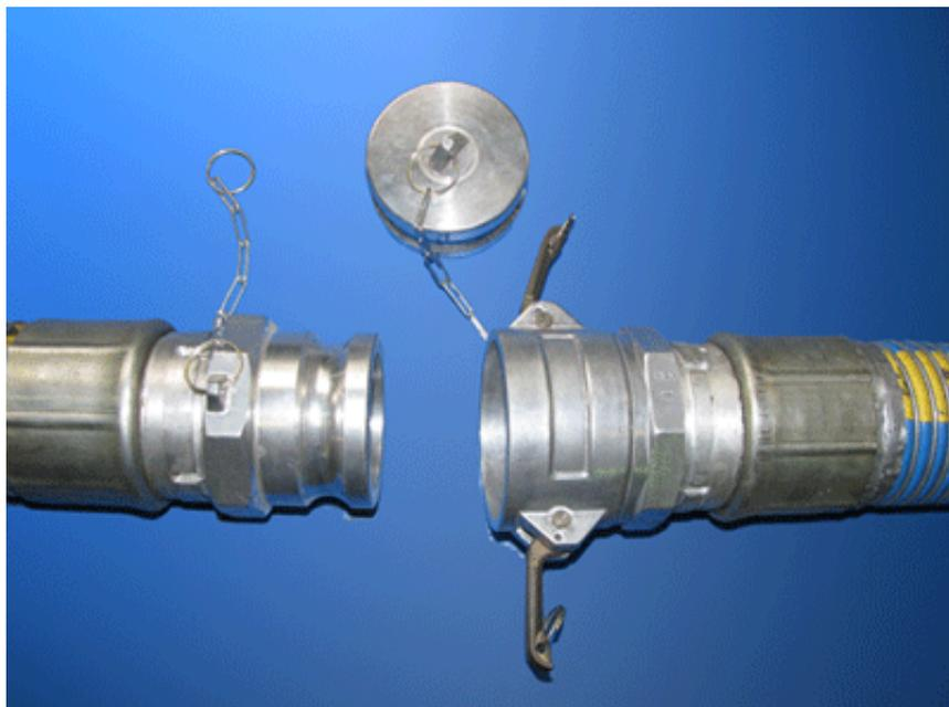
**Назначение:** быстроразъемные соединения БРС- арматура для комплектации автоцистерн, используемая с целью соединения и разъема трубопроводов с диаметром ДУ 50, 80 и 100, а также для их быстрого открытия-закрытия и соединения в одну нить.
