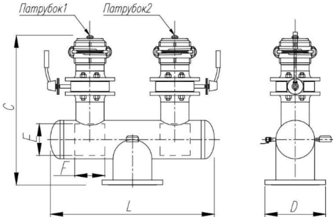
**Узел для подключения пожарной техники УПТ** на две ГМ-150 служит для присоединения пожарных рукавов и посредством их происходит подача водопенного раствора от пожарных машин в стационарную систему пожаротушения. Также применяется в процессе отбора водопенного раствора от стационарной системы пожаротушения на переносные пожарные стволы, пеногенераторы применяемые для пожаротушения.
