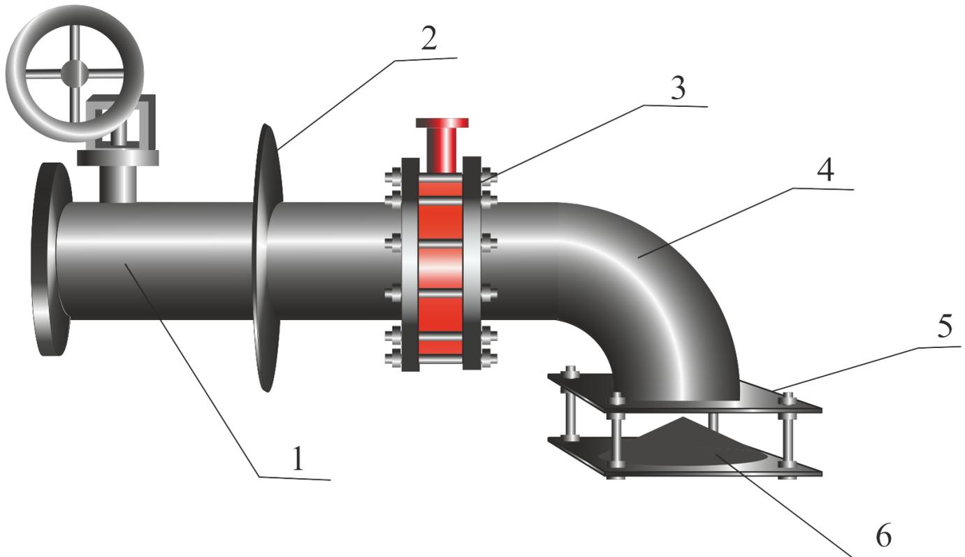
**Назначение:** приёмо-раздаточные устройства серии ПРУ предназначены для слива и взлива нефтепродуктов, авиатоплива в стальные вертикальные резервуары РВС объемом от 100 до 50000 м<sup>3</sup>. Также ПРУ позволяют предотвратить потери продукта вследствие разрыва трубопроводов или выхода из строя размещенных на них запорных устройств.
