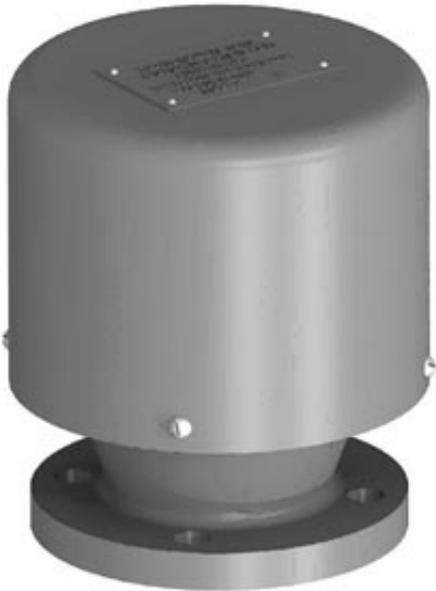
**Назначение:** клапаны дыхательные КДМ-ОТР (неприморзаемые, что соответствует требованиям Правил Ростехнадзора ПБ 09-560-03) в комплекте с огнепреградителями повышенной огнестойкости применяются для герметизации газового пространства резервуаров с нефтью, нефтепродуктами и другими продуктами, а также для регулирования параметров давления и вакуума в заданных пределах.
